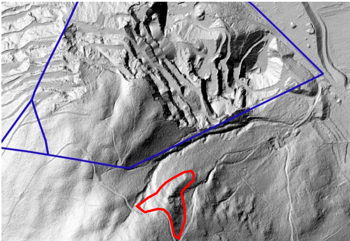
Fig.20 carta dell'ombreggiamento ottenuta da dati LiDAR PAT 2014 ove si nota l'evidente incisione presente a confine con l'area estrattiva, le potenziali zone sorgenti di crolli sono evidenziate in colore rosso
