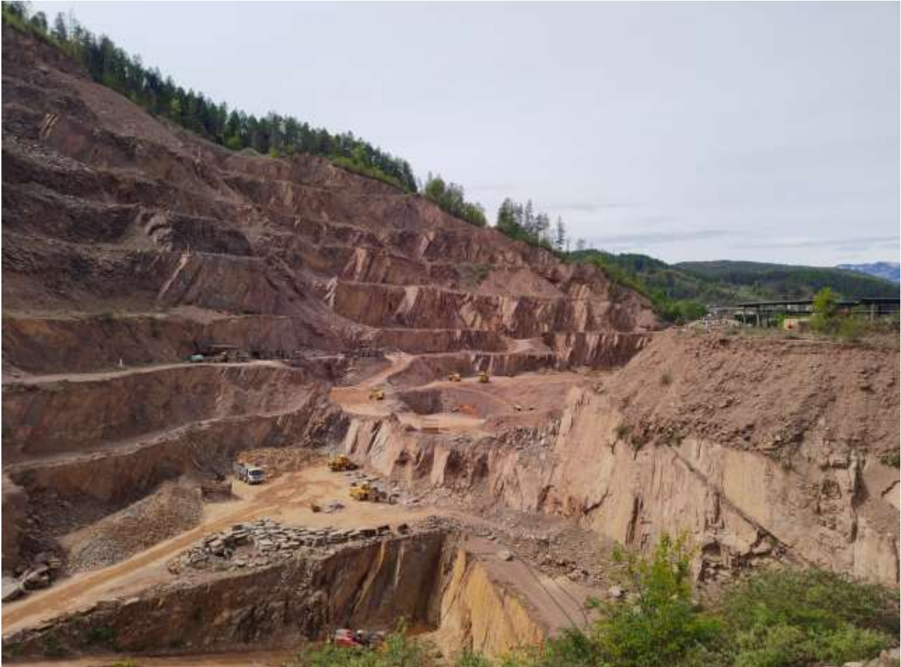
Fig.1 panoramica dell'area estrattiva su Albiano, si nota in primo piano e sullo sfondo l'ammasso roccioso integro, nella porzione sinistra della foto l'ammasso roccioso scompaginato e nella porzione destra della foto il materiale di discarica
