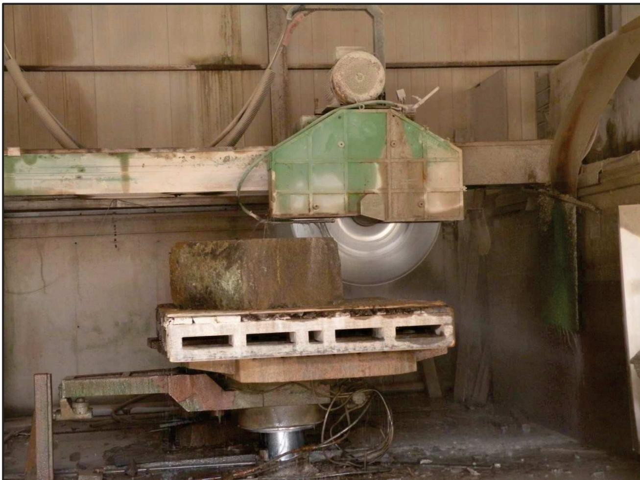
**Figura 8: Esempio di sega a ponte**
