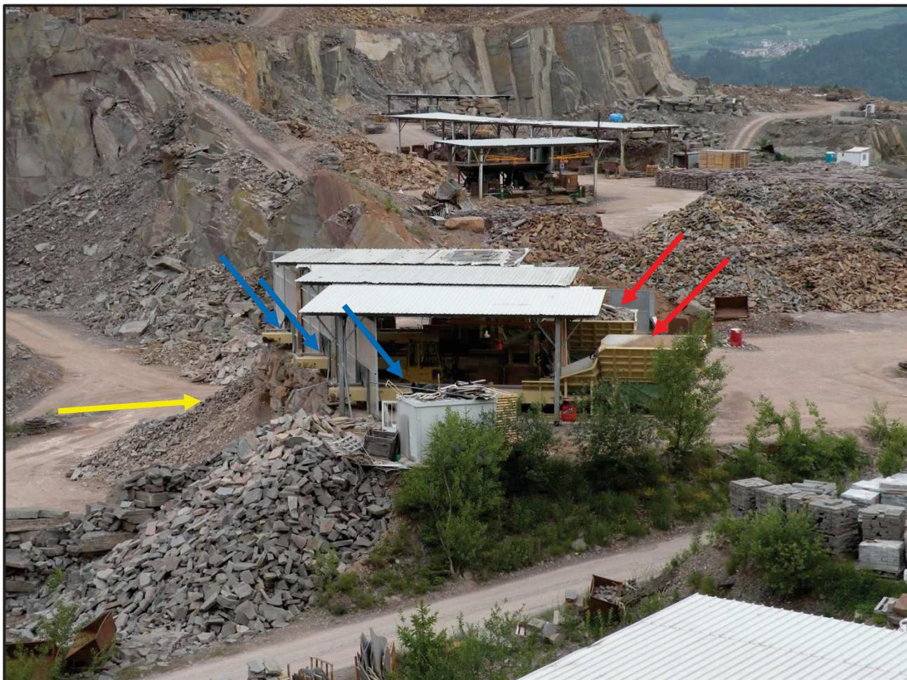
**Figura 5: Esempio di banconi di cernita installati sul lotto n. 9 Monte Gaggio**
