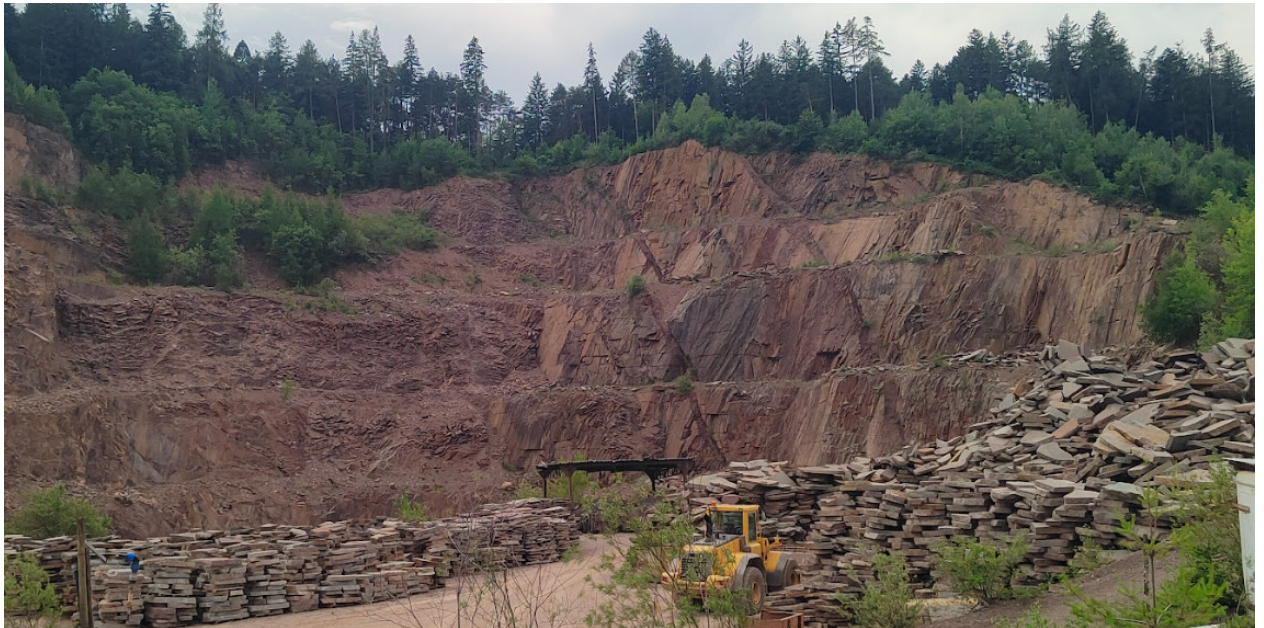
Panoramica del fronte di avanzamento verso sud nell'area di S.Colomba ove si osservano le fasce cataclasate che favoriscono l'innesco della rotazione dei fronti in avanzamento verso sud.
