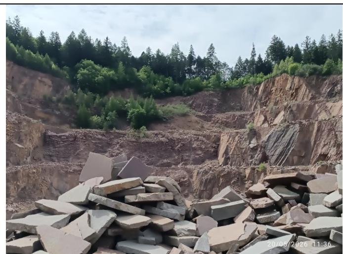
Foto 1. Area estrattiva Santa Colomba: l'attività di coltivazione ha determinato la completa asportazione del suolo forestale (cappellaccio) con rimodellamento dei versanti a formare dei gradoni su cui difficilmente si insedia la vegetazione pioniera
